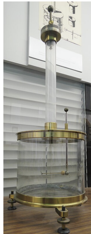
Nachbau der originalen Coulombschen Drehwaage im Deutschen Museum in München
